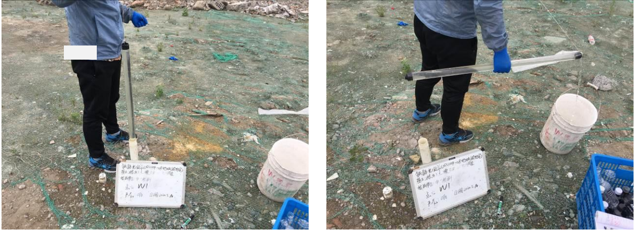
图 5.2-4 地下水洗井、取样现场图
