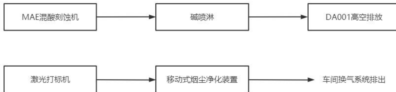
图 3-1 全厂废气处理系统图
